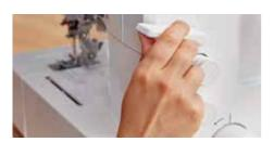
Lösen der Fadenspannung
