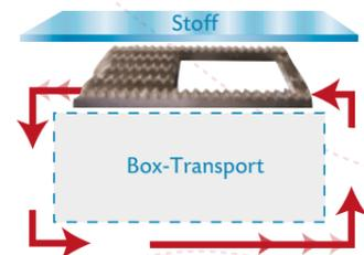
Da der Transporteur länger Kontakt zum Stoff hat, transportiert die Maschine das Nähobjekt besser.
