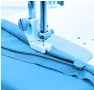
*Nähfuß für nahtverdeckten Reißverschluss (Kunststoff):*
