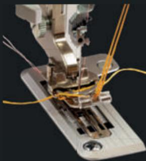
Der Pendelfuß der Primo unterscheidet sich von den Standardfüßen, die bei den meisten Cover-Maschinen zu finden sind. Da die Fadenleger in den Nähfuß integriert sind, werden Schaft und Nähfuß zu einer Einheit kombiniert. Die Fadenleger am Pendelfuß bilden den Top Coverstich.
