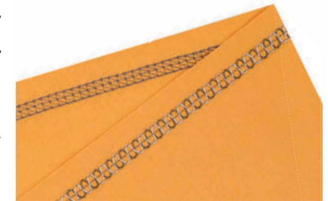
Bei der Nutzung beider Fadenleger entstehen Nähte mit besonderem „Swing“. Die beiden Fäden werden bei dieser Stichgruppe abwechselnd mit halbkreisförmigem Schwung auf die Covernaht gebracht.
