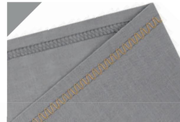
In die Fadenleger lassen sich nicht nur Standardnähfäden einlegen, sondern – und hier geht der Spaß so richtig los – auch Dekorfäden verschiedenster Stärken oder Glanz- und Bauschgarne. Sie werden mit Hilfe des Pendelfußes zu beeindruckenden Kreationen zusammengefügt. Genäht wird in Kombination mit Ketten- oder Coverstichen, sodass die Rückseite denen der jeweiligen Covernähte entspricht.
